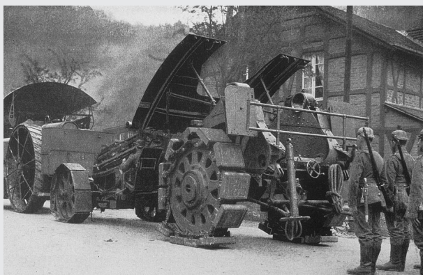
Fig. 65. Tracteur loco-mobile Daimler avec des patins aux roues de la plate-forme pour répartir la charge. coll.privée..
